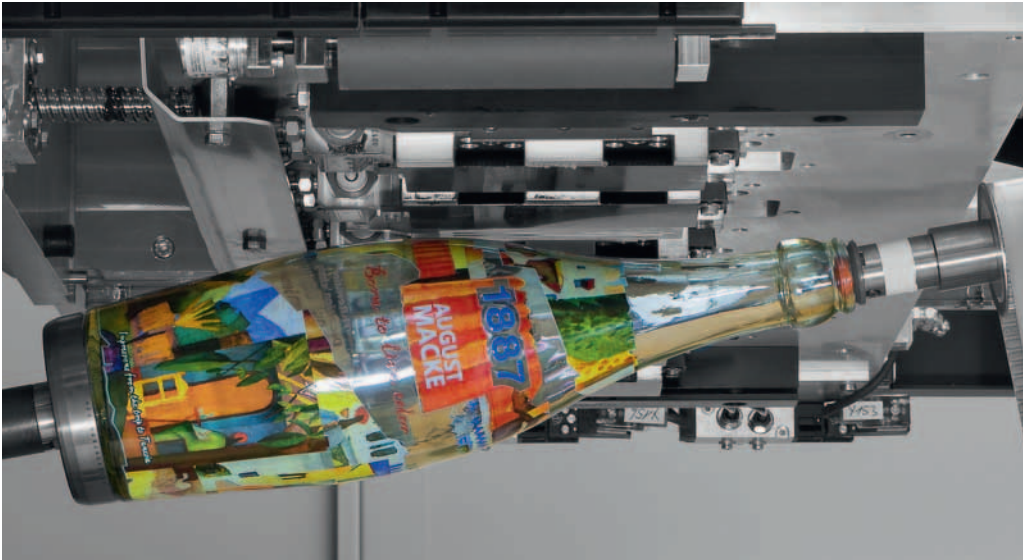
Eine Glasflasche wird in sehr geringem Abstand unter den Inkjetdruckköpfen entlanggeführt.
