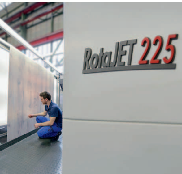
Die bisher größte ausgelieferte RotaJET VL druckt Dekore auf bis zu 2,25 Meter breite Bahnen.
