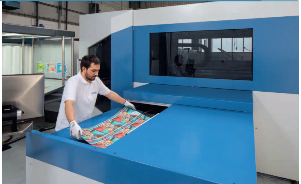
Die Digitaldrucklösung MetalDecojet setzt wasserbasierende Druckfarben ein.
