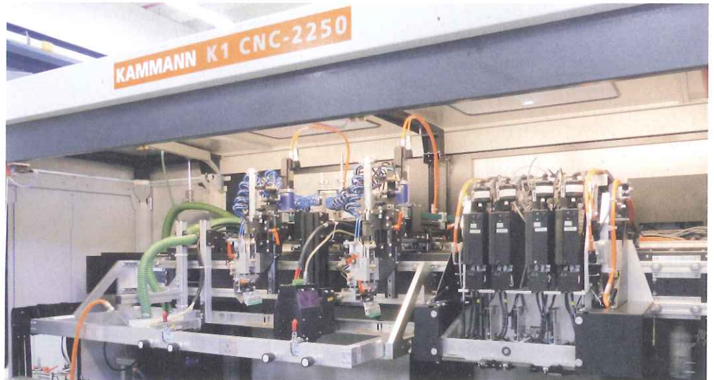
Die Kammann-Linie mit kombinierter Siebdruck- (l.) und Inkjet-Druckeinheit hatte 2013 auf der Messe „K“ Premiere. In Kürze wird sie erstmals bei einem Kunden installiert.
