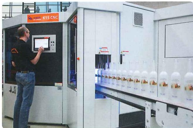
Von der Ein- und Ausgabrobotik über den Konus-Siebdruck bis zum kontaktlosen Digitaldruck auf Hohlkörpern aus Glas, Kunststoff und Metall – die K15 CNC erfüllt viele Wünsche. (Foto: KBA)
