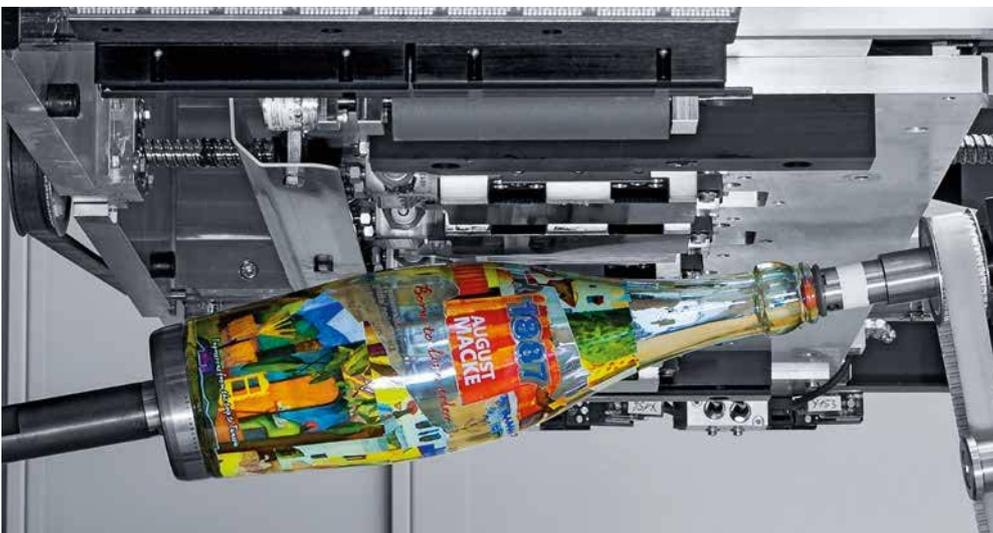
à se déplacer, parfois à plusieurs reprises. Une solution au niveau du logiciel devrait permettre prochainement de rendre invisibles les raccords. Une autre solution est l'impression « en spirale » qui requiert une parfaite synchronisation entre logiciel, têtes jet d'encre et transport des articles.
